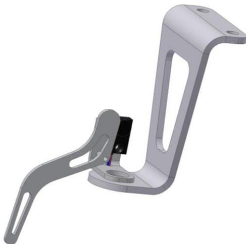
Abb.3.8-1: Bodenkontaktsensor mit federbelasteten Hebel, der einen induktiven Schaltkontakt auslöst.
