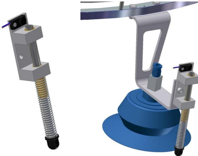
Abb.3.8-2: Bodenkontaktsensor mit federbelasteten Schaltstift, der induktiven Schaltkontakt auslöst.
