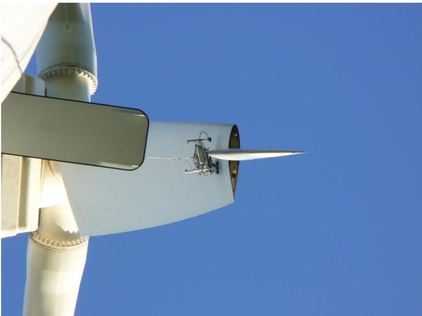
Abb.3.14-8 Roboter an der Flügelspitze
