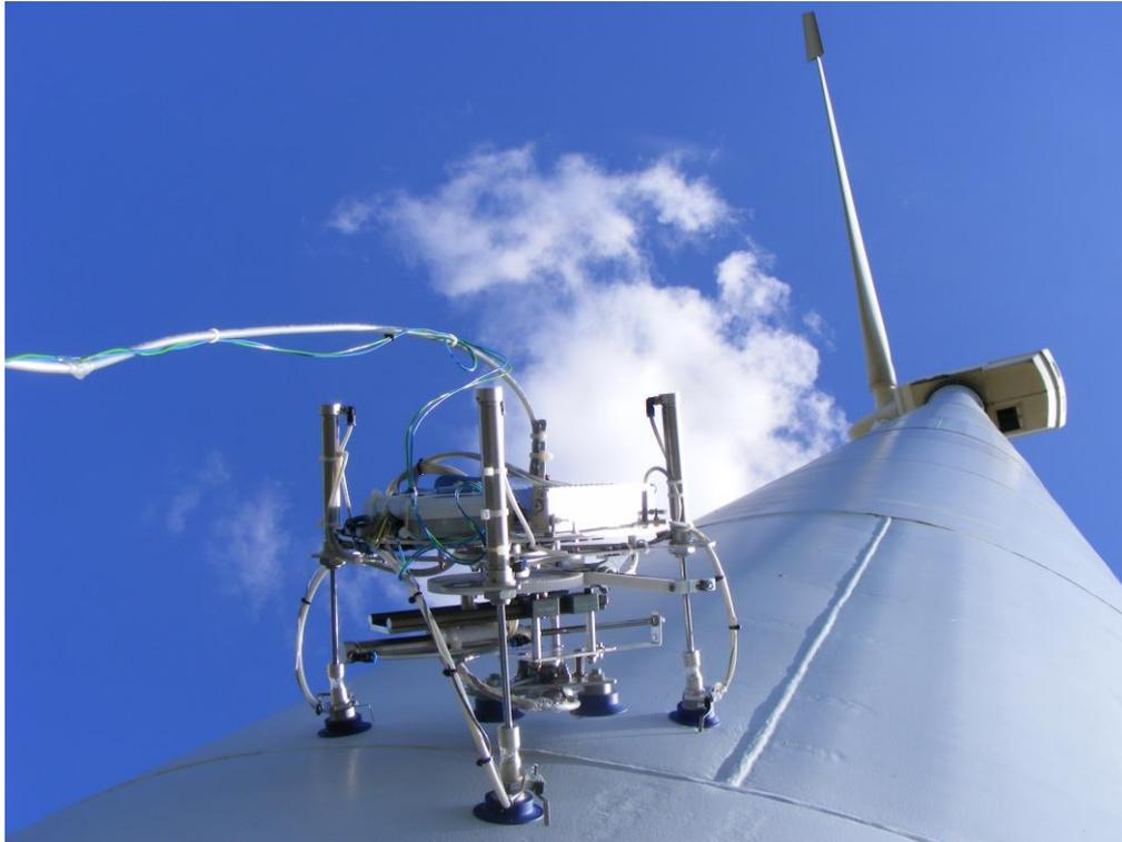
Abb.3.14-2: Roboter am Turm der Windkraftanlage, möglicher Einsatz wäre die Prüfung von Schweißnähten
