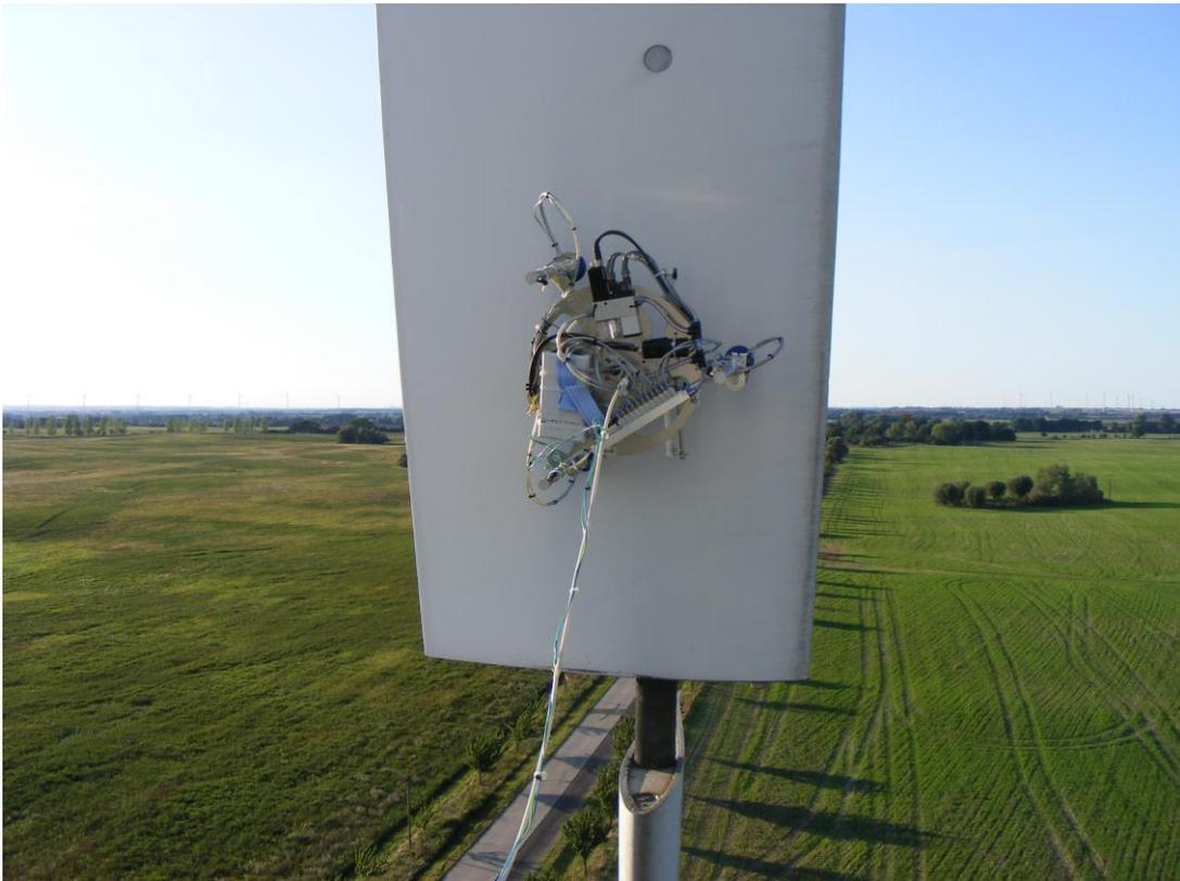
Abb.3.14-4: Roboter an der Rotorblattspitze, es handelt sich um ein Rotorblatt mit eingebauter Flügelspitzenbremse, wie bei „Stallanlagen“ üblich.
