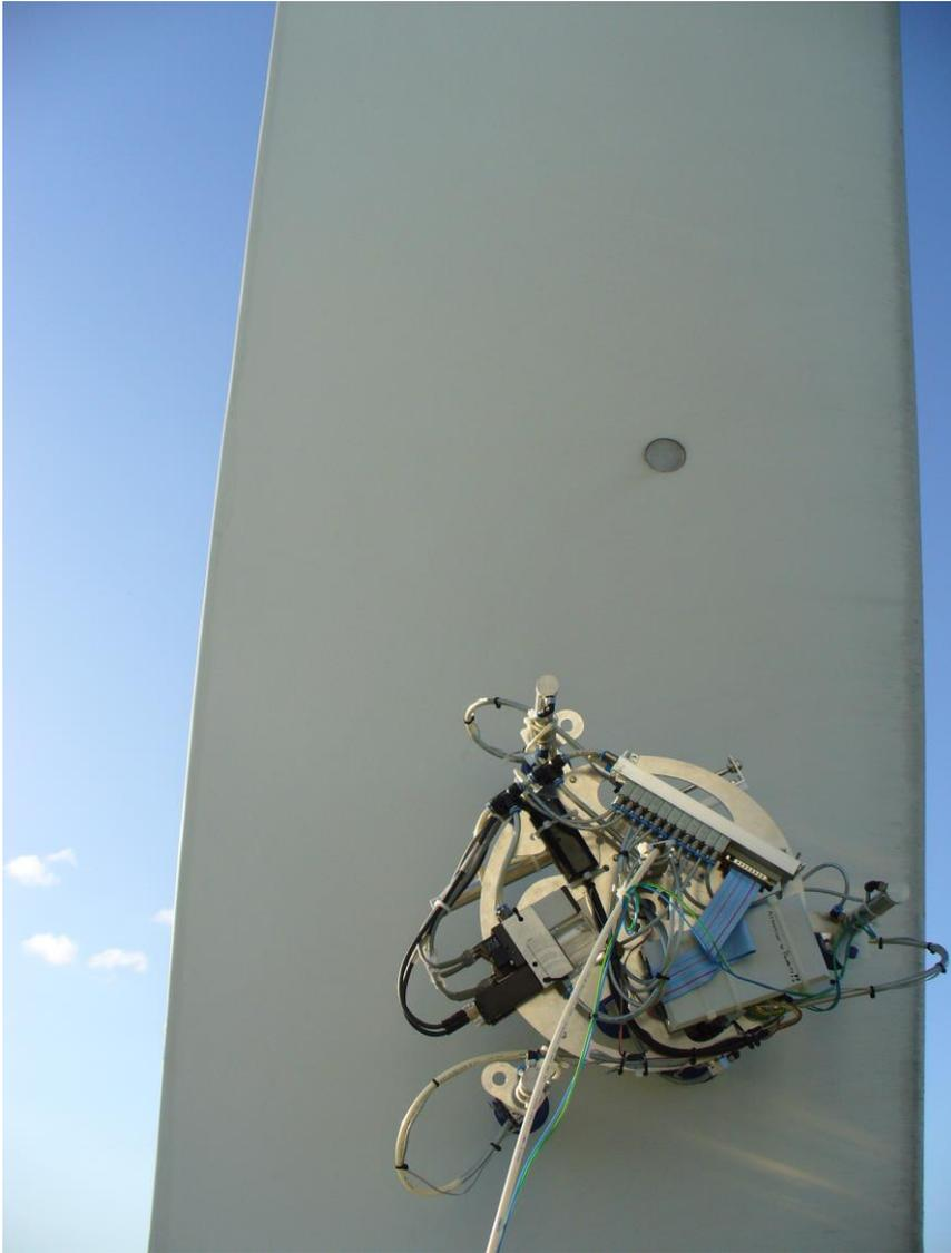
Abb.3.14-9: Roboter am Rotorblatt
