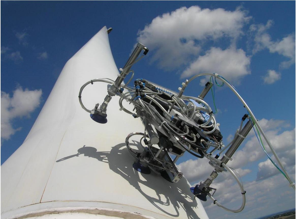
Abb.3.14-7: Roboter am Rotorblattfuß
