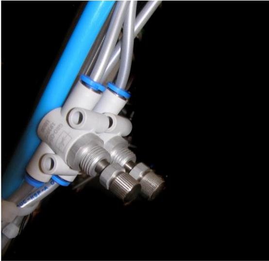
Abb.3.8-5: Druckminderventile vor den pneumatischen Bremsen zur Einstellung des Bremsdrucks.
